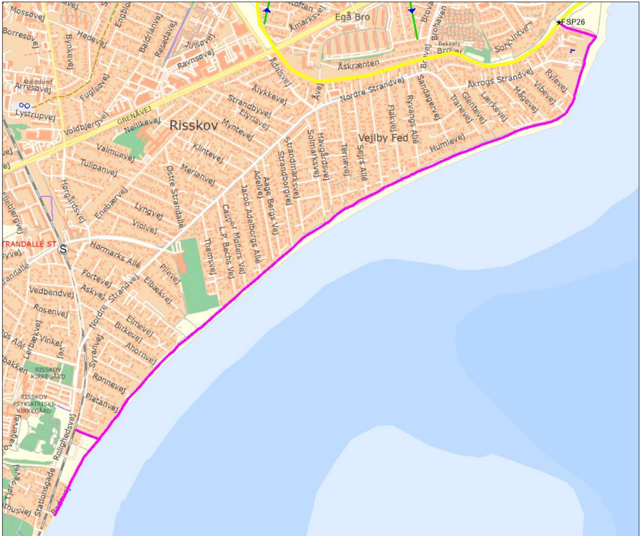
Figur 4-2 Kort over det samlede forløb af diger fra Badevej til Åkrogs Strandvej og slusen angivet med pink linje.
