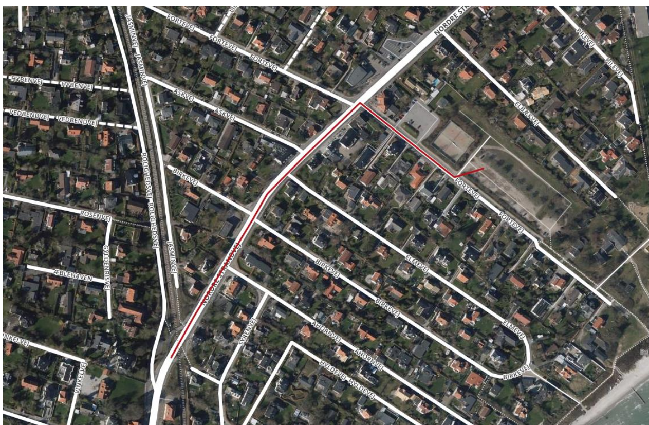
Figur 5-8 Eksempel på skybrudsvej (rød linje) fra Nordre Strandvej ved kystbanen til parkeringsareal ved Fortevej.
